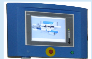
Ecran tactile 15" couleur avec console de commande
